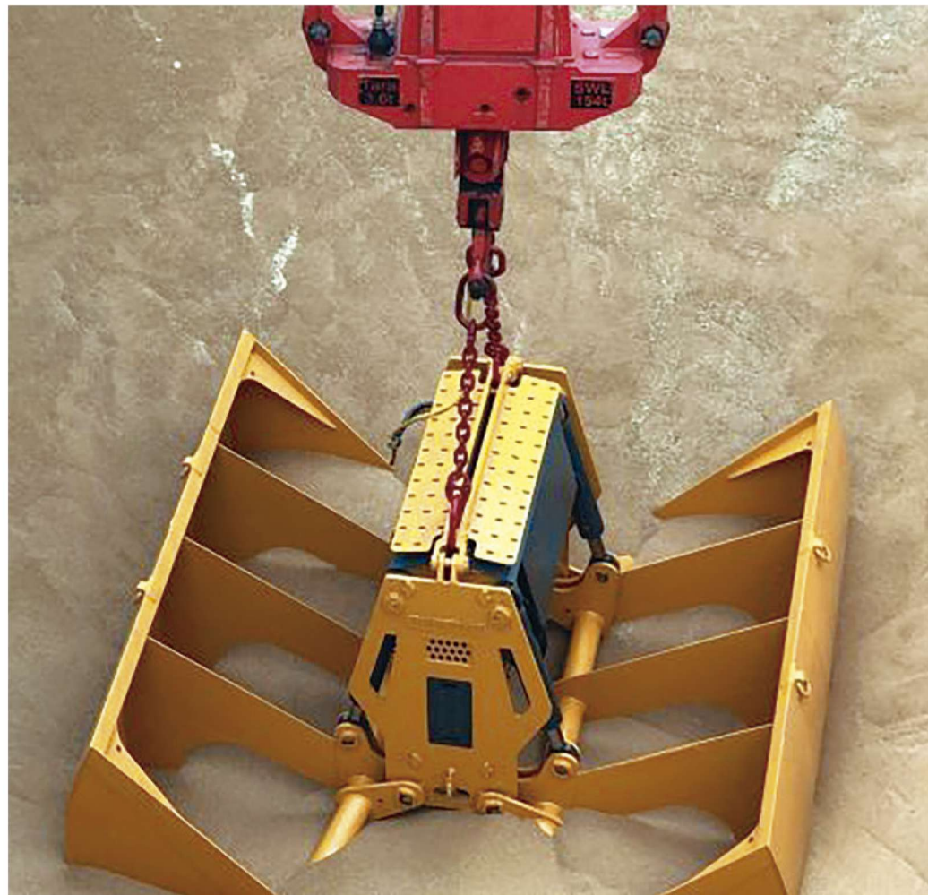
Cuchara STEMM de 40 metros cúbicos para la manipulación de cereales en la descarga de buques.
